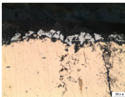
图七 2012FZYM23-12 铜锡 71131 金相照片,冷锻
